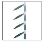
Sistema de protección solar para fachadas. Dicho sistema de lamas en aluminio de extrusión permite la regulación de la luz consiguiéndose notables ahorros en la refrigeración interior de los edificios debido a la creación de zonas de sombra que reducen la incidencia energética a la que son sometidos éstos.
